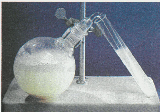
ΣΧΗΜΑ 1.1 Ζύμωση ζάχαρης για την παραγωγή αιθανόλης. Το \text{CO}_2 που ελευθερώνεται κατά τη διάρκεια της ζύμωσης θολώνει το διάλυμα \text{Ca}(\text{OH})_2 (ασβεστόνερο).
