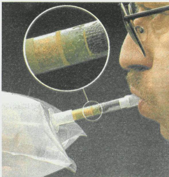
ΣΧΗΜΑ 1.3 Αν ο αέρας της εκπνοής περιέχει αιθανόλη τότε αλλάζει το χρώμα του γυάλινου σωλήνα που περιέχει οξινισμένο \text{K}_2\text{Cr}_2\text{O}_7 .
