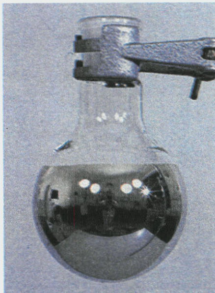
ΣΧΗΜΑ 4.2 Σχηματισμός κατόπτρου με το αντιδραστήριο Tollens.
