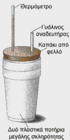
ΣΧΗΜΑ 1.2 Θερμιδόμετρο τύπου πλαστικού κυπέλλου (coffee-cup). Η αντίδραση γίνεται σε υδατικά διαλύματα υπό σταθερή πίεση.
